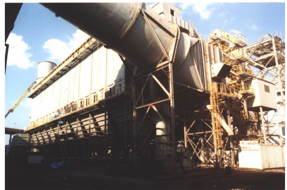
CFT Filteranlage zur Entstaubung eines ägyptischen Stahlwerks
