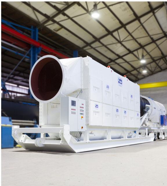
CFT Trockenentstaubungsanlage mit nachgeschalteter Korfmann Ventilatorstation und Verbindungslutte vor der Auslieferung im Werk Gladbeck
