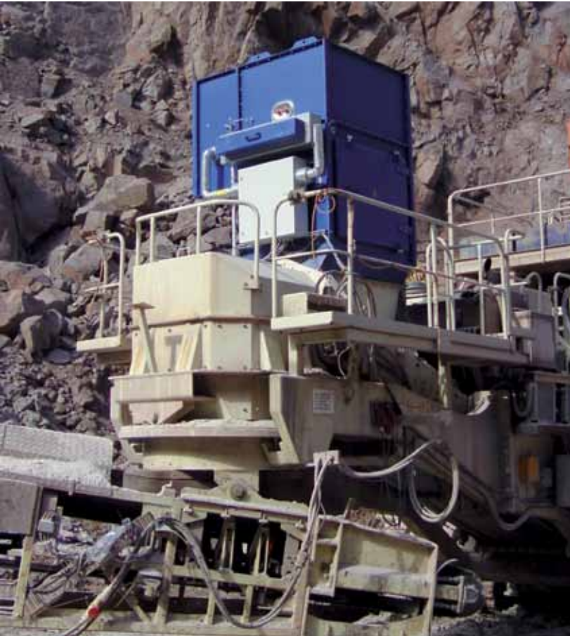
Bilder 2 und 3: Bandaufsatzfilter BAF-VC 900/20-16 für 7.000 m 3 /h mit Kompressor; Einsatz: Siebanlage in einem Schotterwerk
