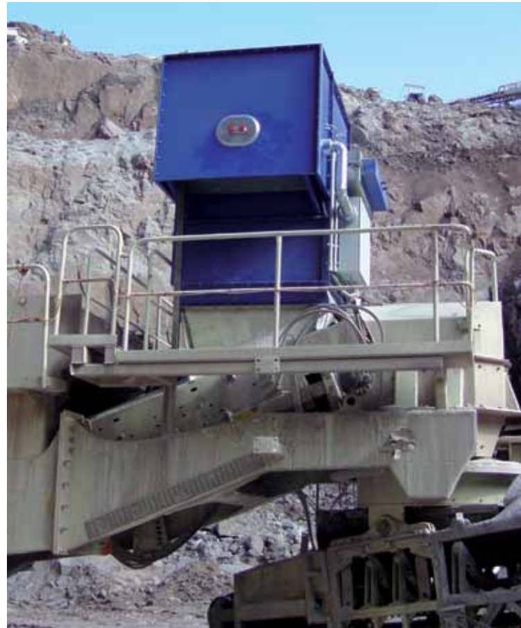
Bilder 2 und 3: Bandaufsatzfilter BAF-VC 900/20-16 für 7.000 m 3 /h mit Kompressor; Einsatz: Siebanlage in einem Schotterwerk
